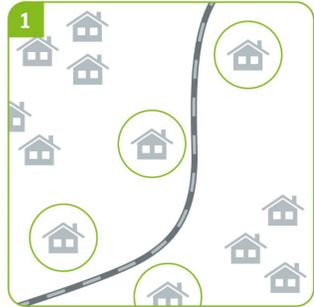
Jedes Gebäude entlang der Bahnstrecke wird schalltechnisch erfasst.
