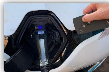
Die Schlüsselkarte benötigen Sie, um das Ladekabel von der Ladestation zu lösen. (Kabel in den Kofferraum legen). Nach der Fahrt sollte der Wagen wieder an die Ladestation angeschlossen werden.
